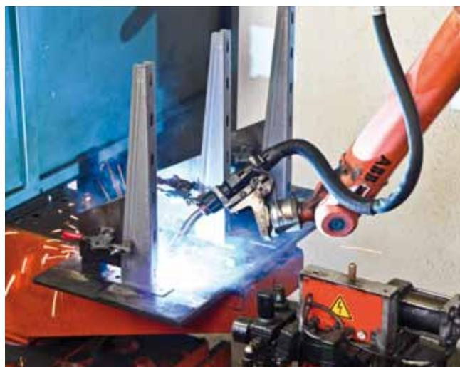
**Reparto saldature eseguite con sistemi robotizzati**
